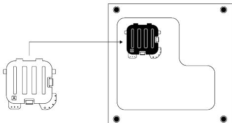
Inclinare leggermente la lavatrice all'indietro. Appoggiare le linguette del coperchio A sul pannello inferiore. Completare il montaggio ruotando il coperchio.
