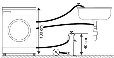
4. Per evitare che l'acqua di scarico torni di nuovo nella lavatrice e per garantire un facile drenaggio, non immergere l'estremità del tubo nell'acqua di scarico o non inserirlo nello scarico per più di 15 cm. Se è troppo lungo, accorciarlo.
